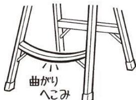
④ 各部件的连接处是否出现破损、严重腐蚀等现象。以及，零部件是否出现破损、脱落、变形、磨损、严重腐蚀等现象。若出现上述现象**请勿再使用**，建议报废处理。
