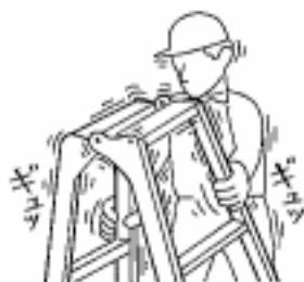
③ 请确认左右锁扣有无确实锁定。不能确实锁定的情况下，**请勿再使用**，建议报废处理。
