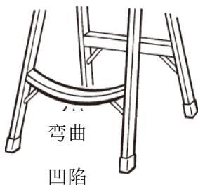
④ 各部件的连接处是否出现破损、严重腐蚀等现象。另外，安装的零部件是否出现破损、脱落、变形、磨损、严重腐蚀等现象。若出现上述现象请勿再使用，建议将其报废。
