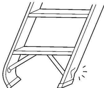
③ 天板和踏板是否出现弯曲、凹陷。若出现弯曲、凹陷现象请勿再使用，建议报废处理。
