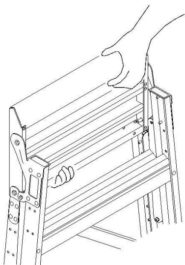
2. 支柱（背面）放于地面，慢慢将作业台打开，使天板处于水平面。
