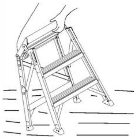
2. 将天板折叠至和支柱平行，然后确认锁扣已确实锁住。
