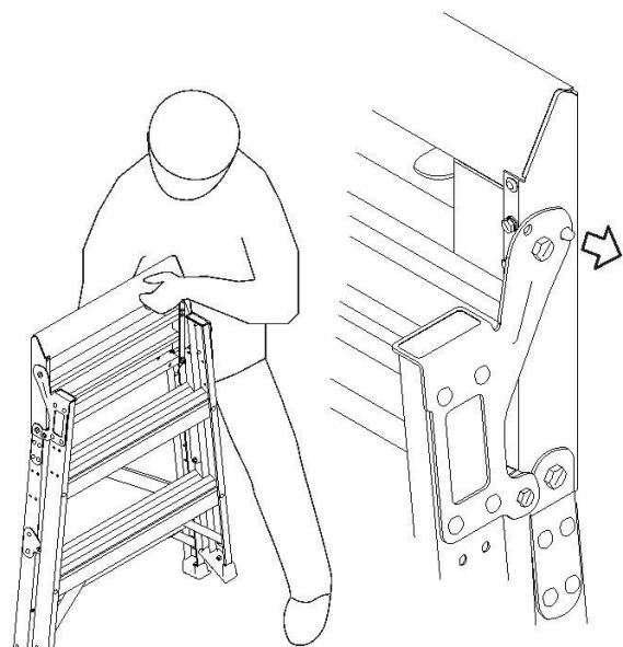
3. 打开作业台后，手离操作杆。最后再确认一下锁扣是否确实锁住。
