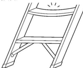
④ 各部件的连接处是否出现破损、严重腐蚀等现象。以及零部件是否出现破损、脱落、变形、磨损、严重腐蚀等现象。若出现上述现象请勿再使用，建议报废处理。
