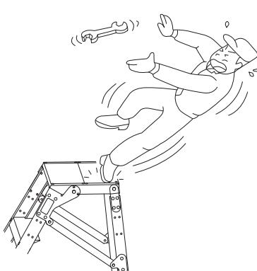
**△ 警告** 作業中に作業台を移動するときは、作業台から一旦降りて移動してください。
