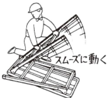
**②** 左右的关节（旋转金属零件）是否有松动或晃动现象。
